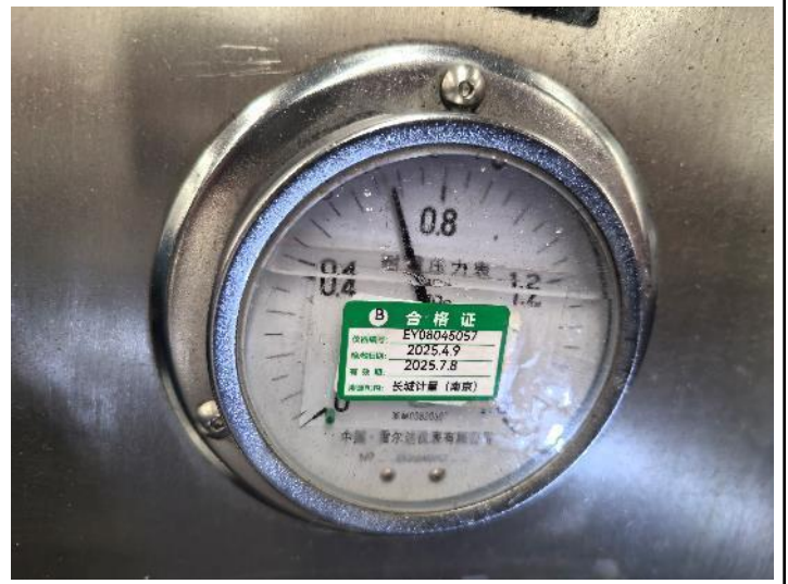
Teste de pressão pneumática a 0,7MPa
