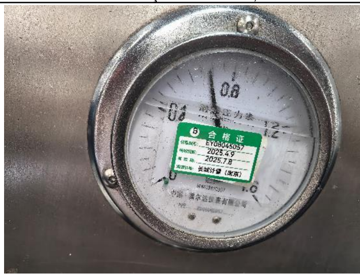
Teste de pressão pneumática a 0,7MPa
