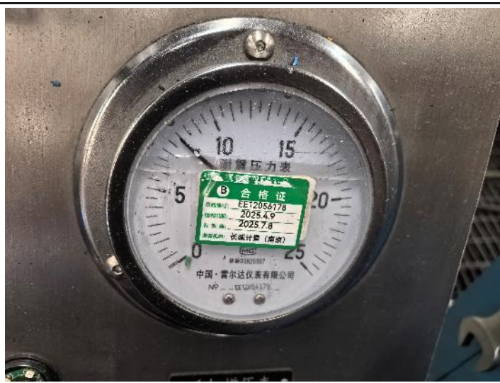
Teste de resistência do casco a 7,8 MPa
